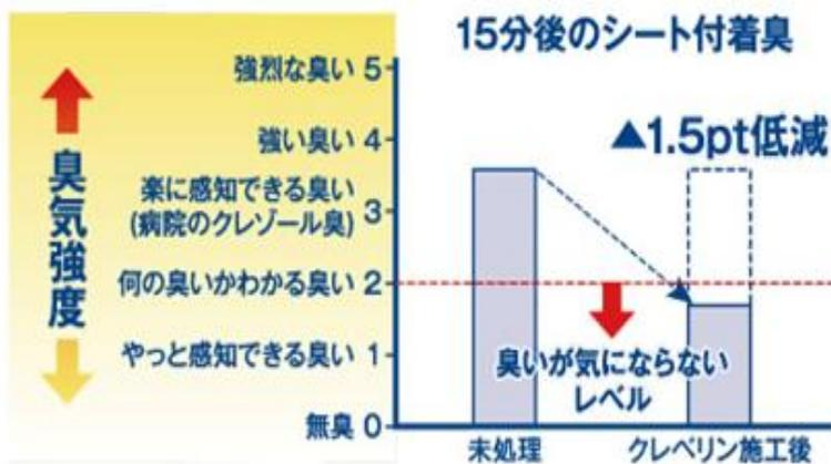
●試験実施先：株式会社デンソー ●試験方法：タバコの煙を付着させた5cm角シート布をC10<sup>2</sup>1.5ppmに安定させたチャンバー内で、15分間ガスに曝露させた。その後、布と空気を3Lの臭い袋に封入して2日間静置し、布から出しきった臭いを6段階臭気強度表示法にて評価した。●試験結果：未処理のシート付着臭に対し、C10<sup>2</sup>曝露後の付着臭は臭気強度で1.5pt低減されており、臭気強度2以下の臭いが気にならないレベルまで下がっていた。※上記試験は、ある条件でのタバコ付着臭消臭効果を実証したものです。試験結果は、実使用環境下で同様の結果を保証するものではありません。
