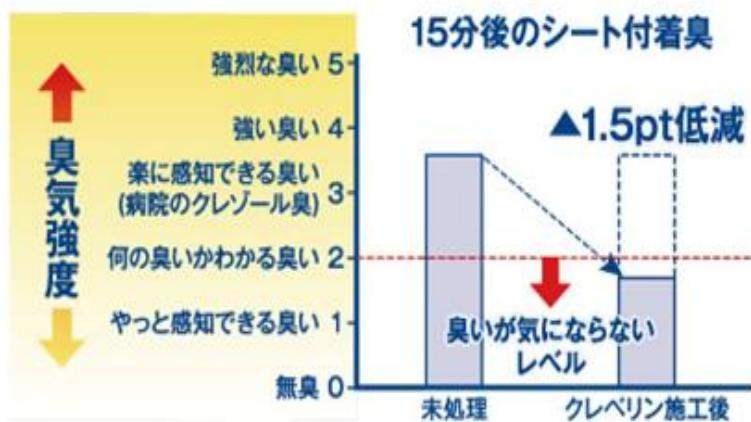
●試験実施先：株式会社デンソー ●試験方法：たばこの煙を付着させた 5cm 角シート布を C10<sup>21.5</sup> ppm に安定させたチャンバー内で、15 分間ガスに曝露させた。その後、布と空気を 3L の臭い袋に封入して 2 日間静置し、布から出しきった臭いを 6 段階臭気強度表示法にて評価した。 ●試験結果：未処理のシート付着臭に対し、C10<sup>2</sup> 曝露後の付着臭は臭気強度で 1.5pt 低減されており、臭気強度 2 以下の臭いが気にならないレベルまで下がっていた。 ※上記試験は、ある条件でのたばこ付着臭消臭効果を実証したものです。試験結果は、実使用環境下で同様の結果を保証するものではありません。
